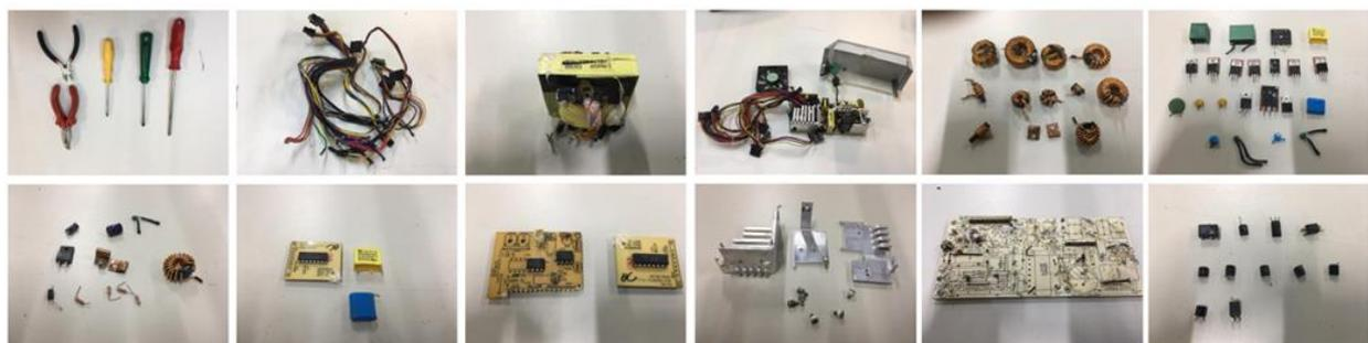
Figura 3. Principais componentes eletrônicos de impressora jato de tinta quarteados
